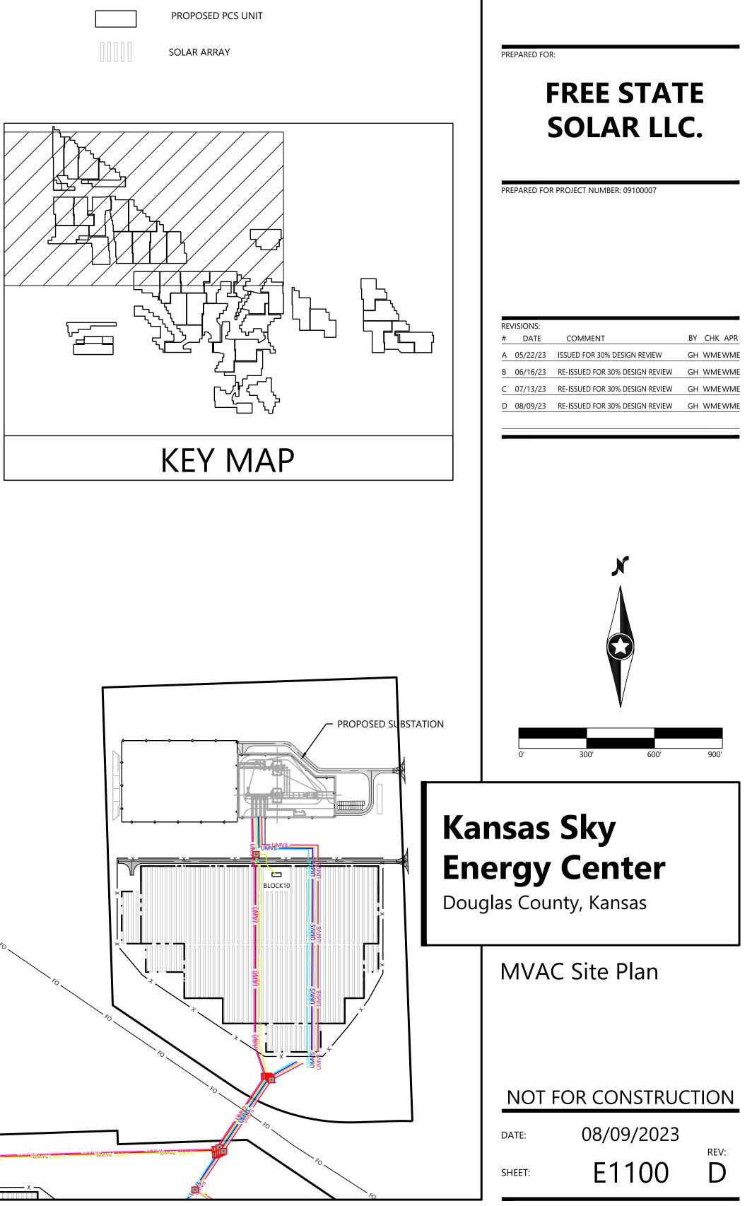
PROPOSED UNDERGROUND MEDIUM VOLTAGE CIRCUIT 1 PROPOSED UNDERGROUND MEDIUM VOLTAGE CIRCUIT 2 PROPOSED UNDERGROUND MEDIUM VOLTAGE CIRCUIT 3 PROPOSED UNDERGROUND MEDIUM VOLTAGE CIRCUIT 4 PROPOSED UNDERGROUND MEDIUM VOLTAGE CIRCUIT 5 PROPOSED UNDERGROUND MEDIUM VOLTAGE CIRCUIT 6
